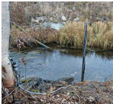
Figur 6 - STS DL/N70 nivågivare på uppströmssidan av trummorna vid Ala Lombolo inloppet. Givaren sitter i ett järnrör och loggern är fastsatt på ett närläget träd
