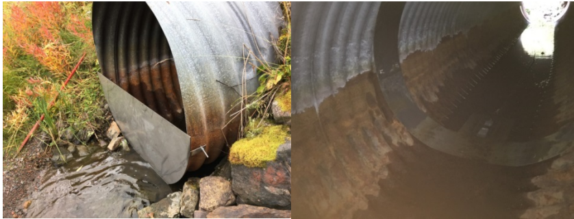
Figur 5- Mätplats vid Ala Lombolos utlopp. Akustiskt dopplerinstrument (Starflow) bottenmonterad i höger bild.
