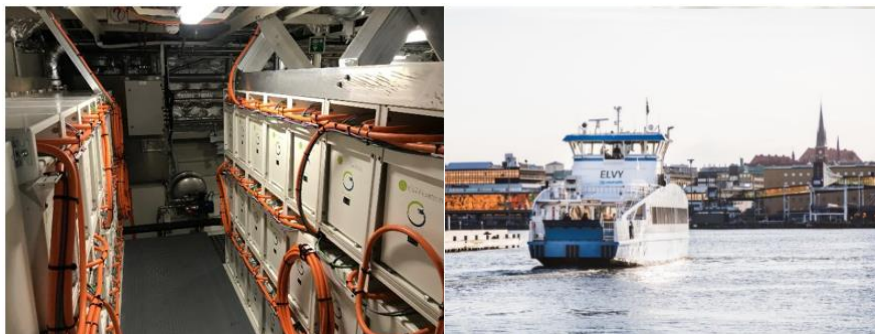
Figur 4 Elhybridfärjan Elvy strax före trafikstart hösten 2019. Bilden visar batteriinstallation och färjan vid dess fasta plats på Lindholmen. Foto IVL respektive Västtrafik.
