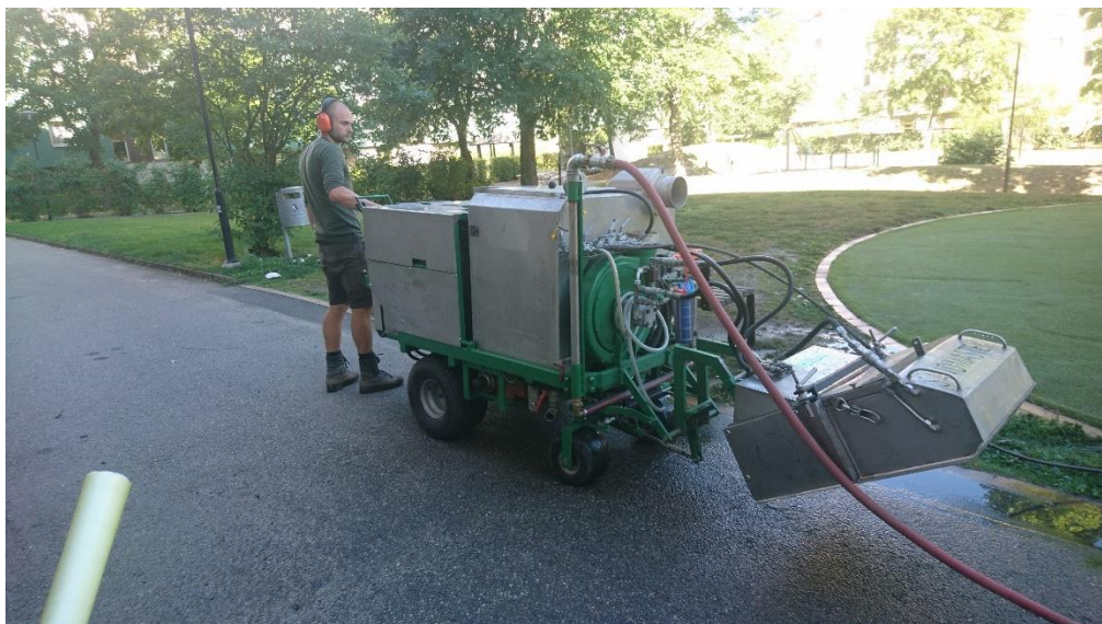
Figur 2. Sandmasters egentillverkade maskin för våtrengöring av gummiytor, vilken användes i projektet.
