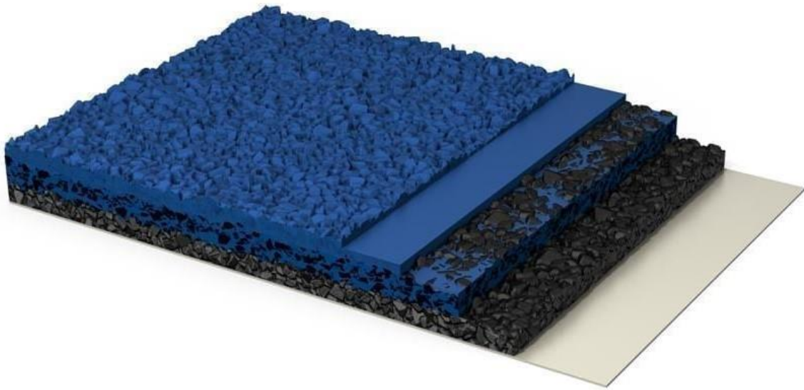
Figur 11. Uppbyggnad av gummiunderlag för löparbanor. Toppskikt vanligtvis i färgad polyuretan (PUR) eller EPDM och botten-skikt i svart SBR-gummi (återvunna däck). Den specifika bilden visar ett vanligt förekommande löpbanematerial med produktnamnet Tartan Gold.
